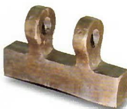
HAMMER BC-36 2 HOLDERS MAT : SCMNH11 WEIGHT : 36 KGS.
