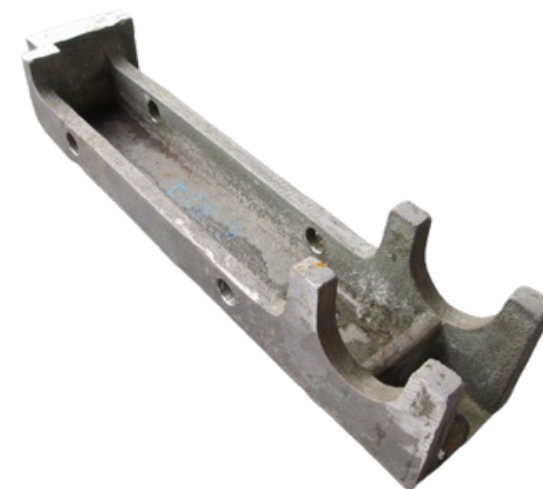
NAME : GRATE BAR B MATERIAL : 1.4823
